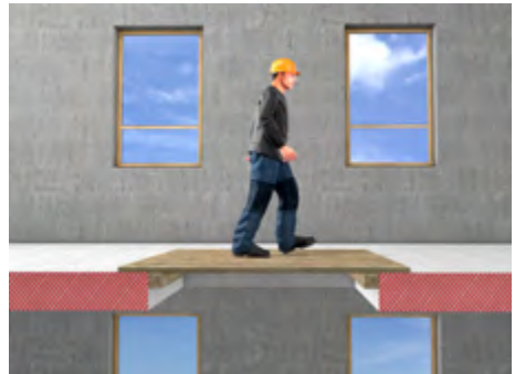
Abb.4: Öffnungen oder Vertiefungen müssen umwehrt oder begehrbar und unverschieblich abgedeckt oder mit tragfähigem Material verfüllt sein.
